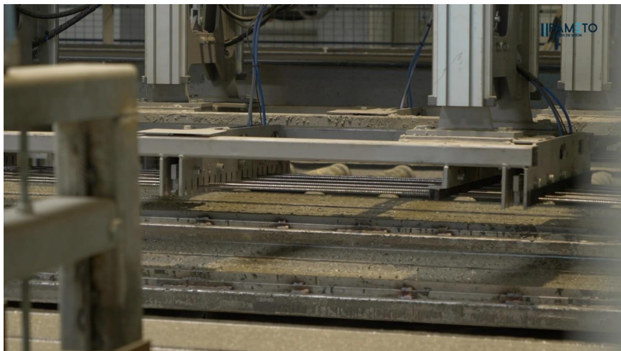
7. Ferro posato in automatico secondo il prodotto.
