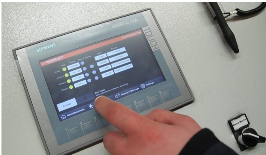
Vue de l'écran de contrôle de la table vibrante OMOCRONOS
