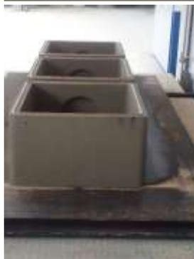
La majorité des tables vibrantes proposées sur le marché permettent uniquement le contrôle de la fréquence de travail. Cette méthode permet de s'éloigner de la fréquence de résonance du moule, mais n'adapte pas la puissance vibratoire idéale au type de béton utilisé pour la fréquence choisie.
