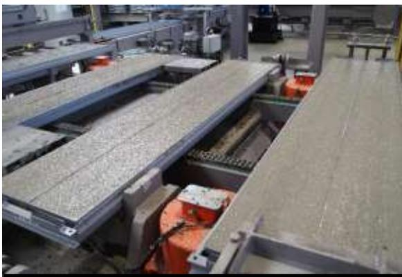
Cette énergie doit être soigneusement régulée pour éviter que des phénomènes de résonance locaux ou globaux ne se produisent, entraînant des phénomènes de désintégration dans le béton, ainsi que des ruptures dans les moules.
